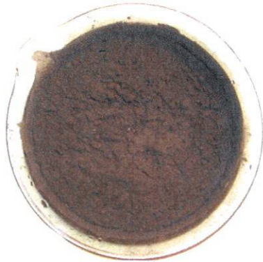
Abbildung 8 Behälter 1 mit trockener Schwimmschicht
