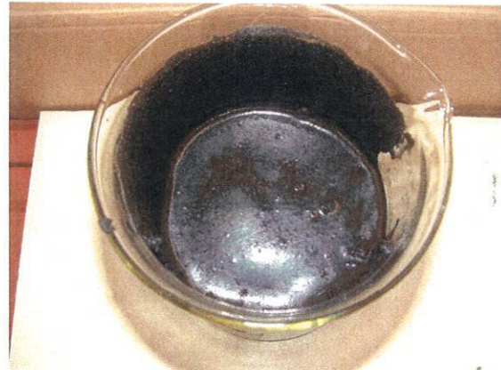
Abbildung 14 Trotz reduzierter Wassermenge hat Behälter 4 eine feuchte Oberfläche
