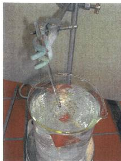
Abbildung 10 Einsatz eines Strömungsbrechers gegen Trombenbildung bei Einmischung von BKS (Bild links: vor Standortoptimierung des Stäbchens, Bild rechts: nach Standortoptimierung)
