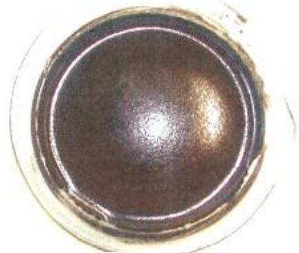
Abbildung 9 Behälter mit vollständiger Benetzung der Oberfläche
