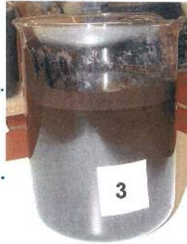
Abbildung 12 Behälter 3 mit Schwimmdecke und verdunsteter Wassermenge (23.11.05)
