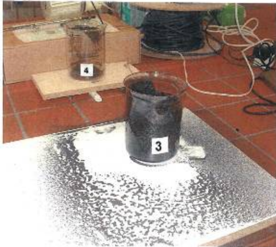
Abbildung 13 Vollständige Austrocknung bei Windgeschwindigkeiten von 6 m/s (Behälter 4)
