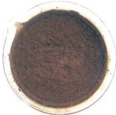
Abbildung 8 Behälter 1 mit trockener Schwimmschicht
